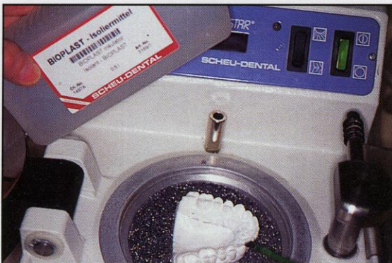
Fig. 4 Bioplast termoformado sobre el modelo de escayola en el Biostar después de la aplicación del medio separador.
